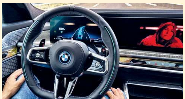
■ Prowadzenie pojazdu bez ciągłego nadzoru, jednak nie bez obecności kierowcy. System poziomu 3 z jazdą na wybranych odcinkach poradzi sobie sam.
