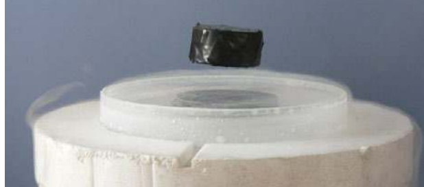
Efekt Meissnera-Ochsenfelda – lewitacja magnesu nad schłodzonym ciekłym azotem nadprzewodnikiem wysokotemperaturowym. https://pl.wikipedia.org/wiki/Efekt_Meissnera ; Fot. Mai-Linh Doan, licencja Wikimedia Commons.
