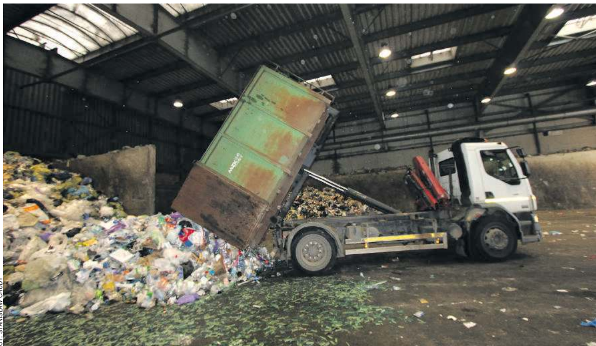
W tym miejscu wysypywane są zmieszane odpady komunalne trafiające do zakładu w Stalowej Woli. Stąd trafiają na linię sortowniczą
