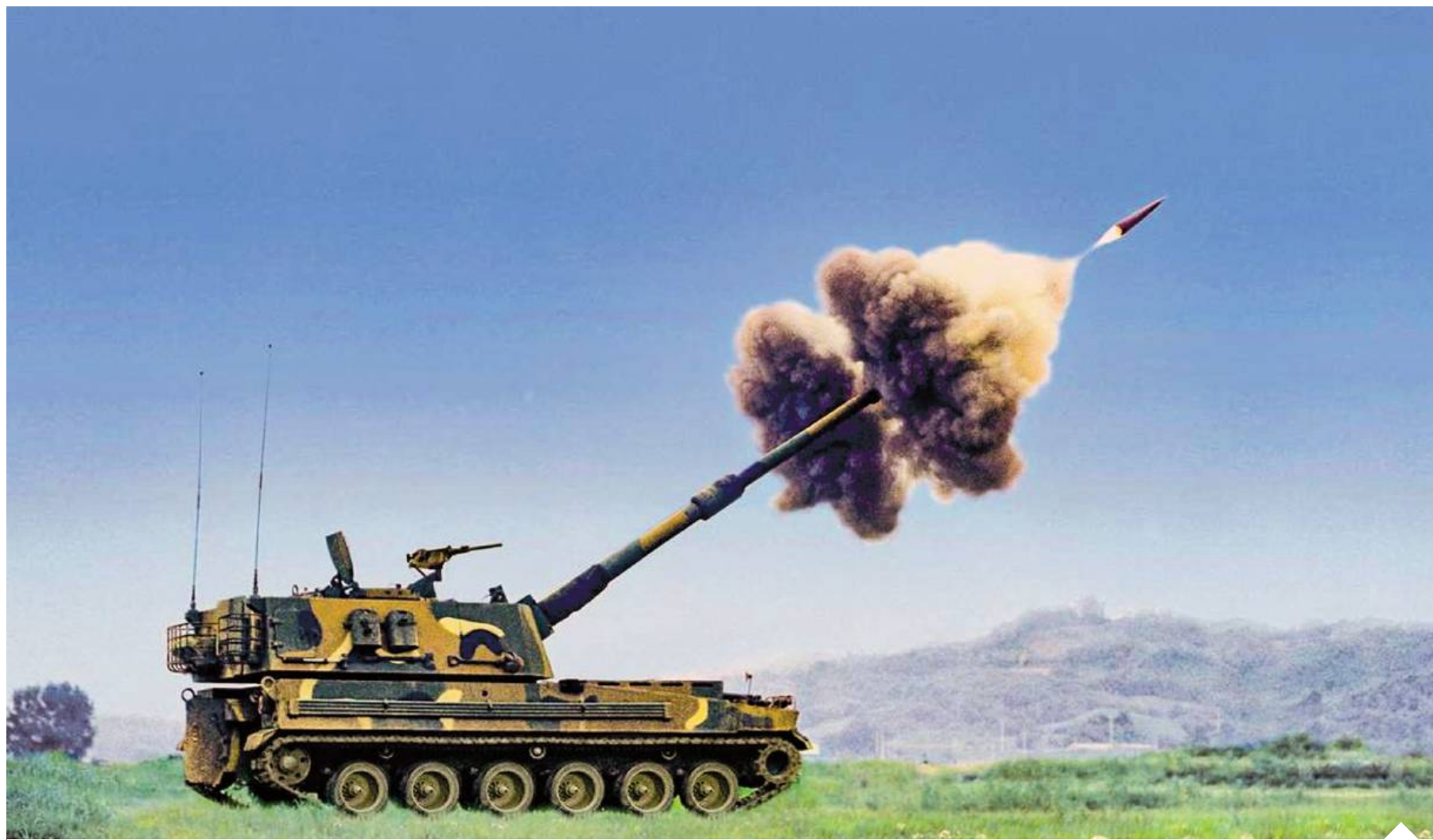
K9 Thunder to południowokoreańska haubica samobieżna na podwoziu gąsienicowym. W wersji K9A1 wprowadzono wiele usprawnień | fot. Wikipedia/d
