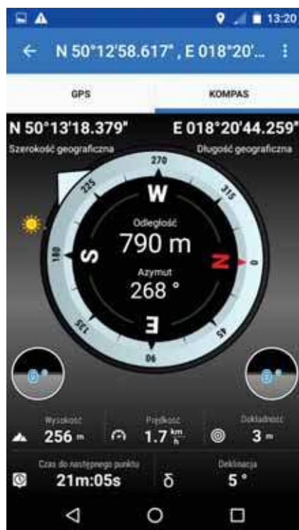
Ekran narzędzia kompas. U góry na niebieskim tle znajdują się współrzędne punktu docelowego, niżej współrzędne punktu, w którym się znajdujemy oraz odległość do celu, azymut na jaki idziemy, nasza aktualna wysokość (wysokość elipsoidalna tzn. nad elipsoidą odniesienia, żeby uzyskać wysokość n.p.m. musimy odjąć 34 m), prędkość z jaką się poruszamy i dokładność pozycjonowania
