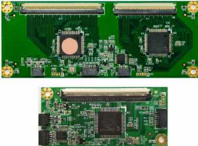
Fotografia 4. Przykładowe moduły kontrolerów wielodotykowych paneli rezystancyjnych ( https://t.ly/-iA-r )
