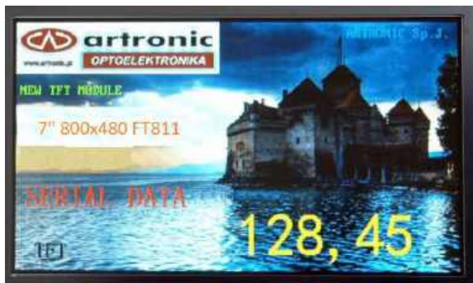
Fotografia 1. Nowy moduł wyświetlacza dotykowego na bazie układów FT811 i FT5446
