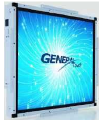
Fotografia 7. Przemysłowy ekran dotykowy z panelem wykonanym w technologii SAW ( https://t.ly/0l1c2 )
