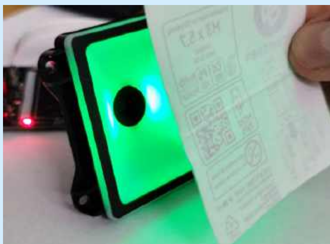
Fotografia 7. Zielone światło potwierdzające poprawny odczyt kodu
