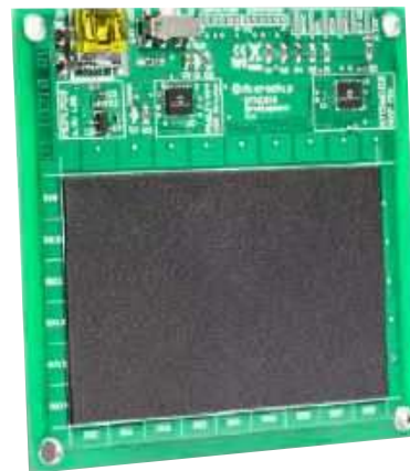
Fotografia 5. Zestaw ewaluacyjny DM160219 firmy Microchip ( https://t.ly/2xDGU )
