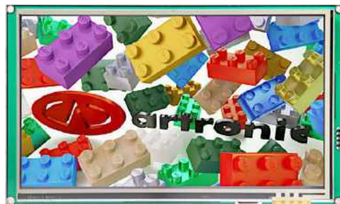
Fotografia 4. Moduł wyświetlacza inteligentnego LCD-AG-TFTSD-UART-800480C-70TP
