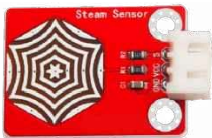
Fotografia 1. Czujnik deszczu i pary Steam Sensor [10]
