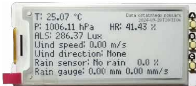
Fotografia 5. Przykład pomiaru bez czujników wiatru i bez opadów
