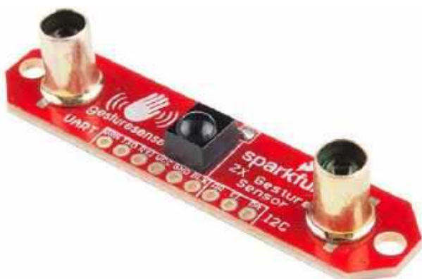
Fotografia 11. Moduł czujnika gestów na bazie nadajników IR i scalonego odbiornika podczerwieni ( https://t.ly/HyFW2 )
