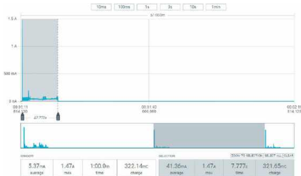
Rysunek 2. Pobór prądu z baterii, pierwsze trzy bloki pomiarowe
