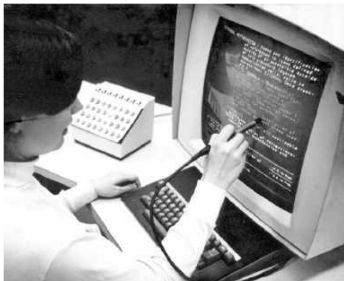
Fotografia 1. Świetlne pióro używane do obsługi komputera IBM – końcówka lat 60. XX wieku ( https://t.ly/PrMli )
