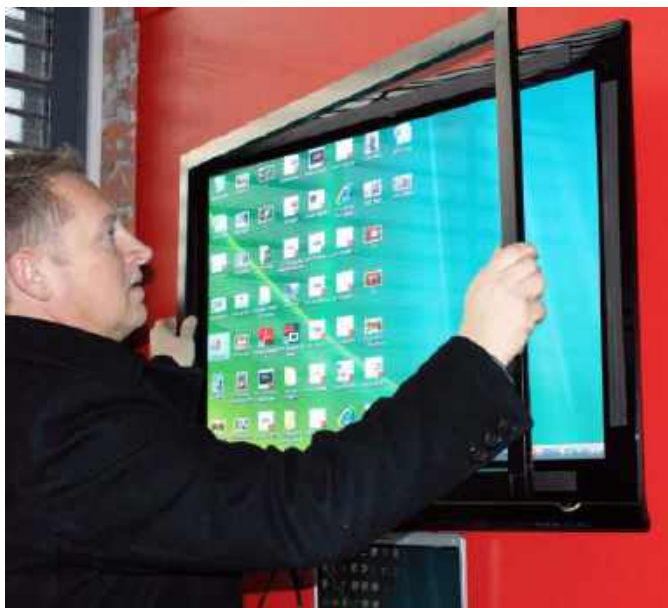
Fotografia 10. Montaż kurtyny IR do istniejącego ekranu ( https://t.ly/JWx3z )
