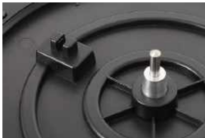
System korekcji prędkości obrotowej wykorzystuje czujniki optyczne.
