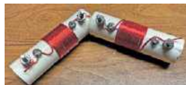
Cewki przedłużające dla pasma 30 m przed ich zaimpregnowaniem i instalacją
