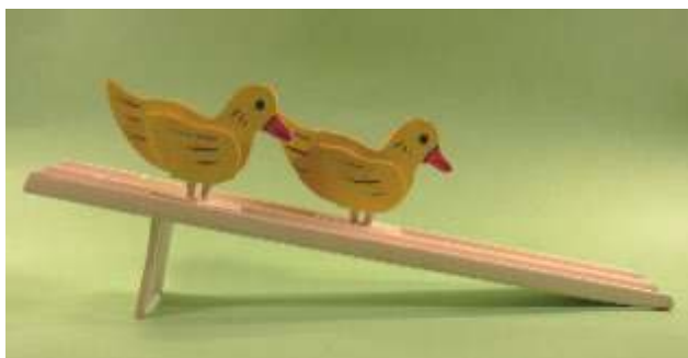
Rys. 8. (a) „Kroczące zwierzęta” to nasz sposób na wprowadzenie pojęcia ruchu jednostajnego. Wbrew pozorom ich konstrukcja nie jest prosta: środek ciężkości, moment bezwładności i krok zwierzątek musi być ściśle dobrany do pochylenia równi. (b) Wyścigi kaczek to super zabawa, w doping, na dużej sali pełnej dzieci (foto GK).
