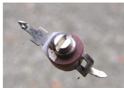
Rysunek 16. Tanie tryмеры ceramiczne, takie jak ten firmy Murata, nie są zbyt stabilne pracując w obwodach Theremina.
