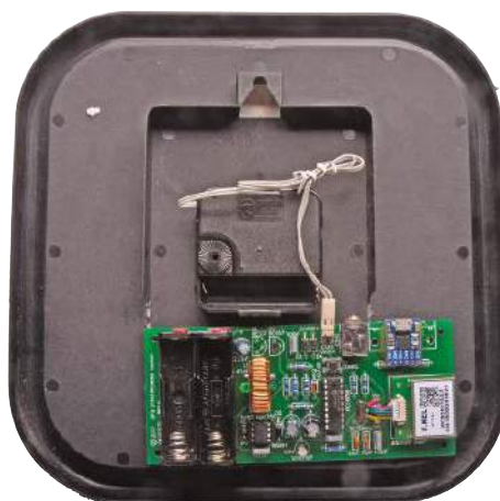
Oto jak przymocowaliśmy płytkę do zegara wskazówkowego – trochę pitowania dla usunięcia kilku występow, a następnie kilka kropel silikonowego uszczelnacza jako kleju. Pokazany sposób mocowania, umożliwia późniejszą łatwą wymianę baterii.
