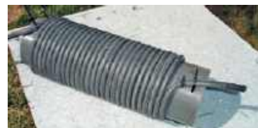
Fot. 1. Dławik składa się z 27 zwojów kabla koncentrycznego nawiniętego na rurce z PCW o średnicy ~11 cm
