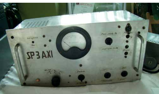
Nadajnik 144 MHz AM/CW skonstruowany przez SP3AXI/SK (lata 60.)
