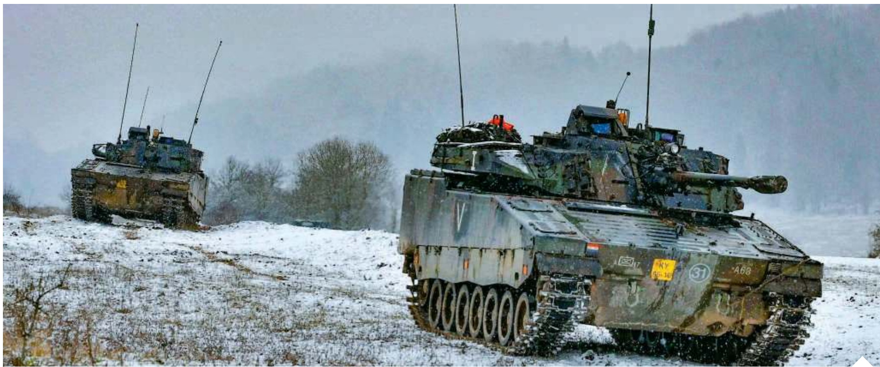
Bojowy wóz piechoty jest w stanie pokonywać przeszkody wodne o głębokości do 260 cm i przeszkody pionowe o wysokości 200 cm | fot. Wikipedia/d
