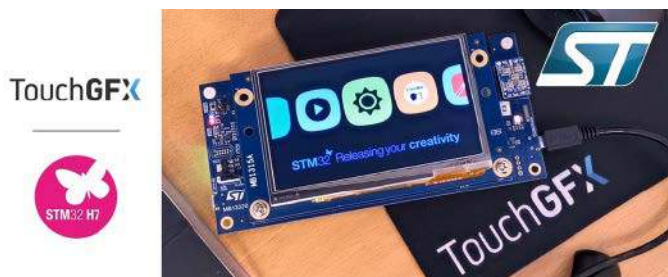
Rysunek 2. Przykładowy moduł z interfejsem HMI zaprogramowanym z użyciem TouchGFX
