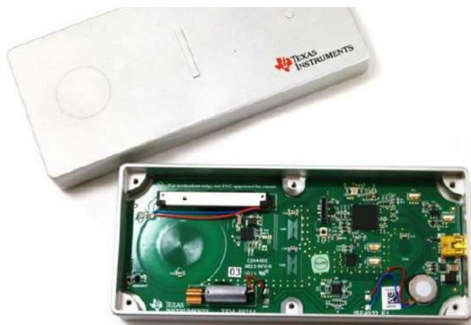
Fotografia 2. Przykładowe zastosowanie przycisków indukcyjnych – zestaw ewaluacyjny frontendu LDC marki Texas Instruments ( https://bit.ly/3HI9mJY )
