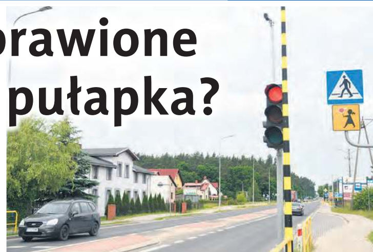
Światło czerwone zapala się w Rudzkim Moście dzięki zsynchronizowanemu z nim miernikowi prędkości. Miernik ustawiony jest na odległość ok. 200 metrów po obu stronach przejścia.
