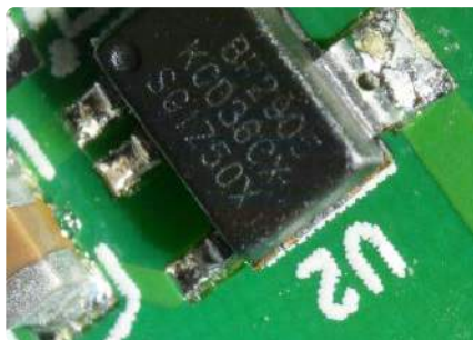
Rysunek 35. Układ BP2905 jest kompatybilny z chipem BP2525
