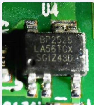
Rysunek 30. Układ BP2525 jest montowany pod płytką drukowaną
