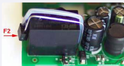
Rysunek 32. Bezpiecznik termiczny zamontowany w pobliżu obudowy przekaźnika
