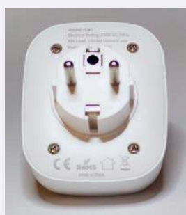
Rysunek 9. Cztery śruby mocujące obudowę EU6S
