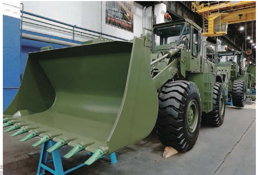
S534, czyli „wojskowa” ładowarka kołowa produkowana w stalowowolskim LiuGongu na zamówienie Huty Stalowa Wola
