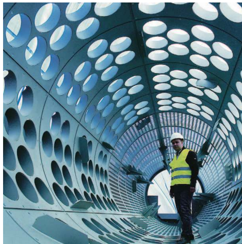
Tak w sierpniu 2014 r. prezentowało się wnętrze wielkiego, 32-tonowego sita, które rok później rozpoczęło pracę na linii sortowniczej Zakładu Mechaniczno-Biologicznego Przetwarzania Odpadów Komunalnych w Stalowej Woli. To na tym sicie po raz pierwszy oddzielana jest frakcja organiczna
