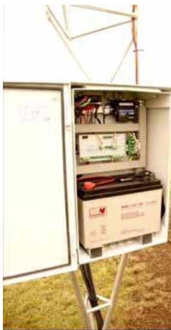
Stacja zdolna jest pracować bez zewnętrznego zasilania, dane rejestruje we własnej pamięci
