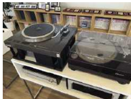
Denon budował jedno z najlepszych gramofonów z napędem bezpośrednim. DP-59M (manualna, a nie popularniejsza wersja automatyczna) i legenda – topowy DP-100 z odprężniętym chassis.
