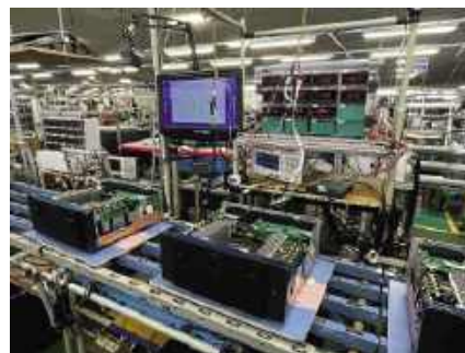
Amplitunery Marantza wjeżdżają na stanowiska finalnej kontroli, podłączane do systemów pomiarowych i monitorów.
