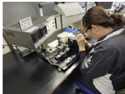
Cewki do wkładek DL-103 są nawijane przez kobiety ze względu na ich zdolności manualne.
