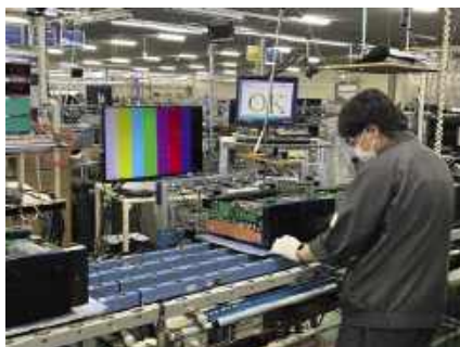
Poprawność działania menu weryfikuje się według specjalnej procedury, tutaj ładowane jest także oprogramowanie.
