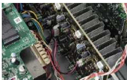
Denon konsekwentnie stosuje końcówki w klasie A/B podłączone do liniowego zasilania.
