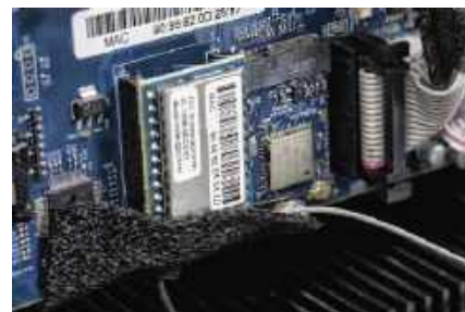
Moduły komunikacji bezprzewodowej znajdują się w pobliżu płytki z układami cyfrowymi.
