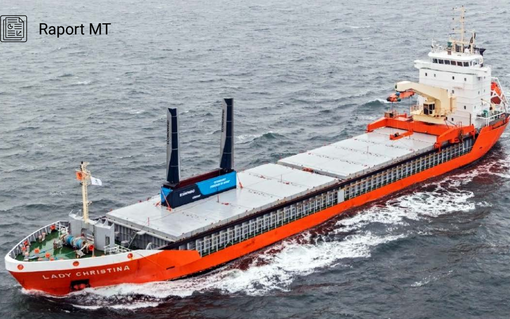
Lady Christina ze skonteneryzowaną wersją żagli od przedsiębiorstwa Econowind (fot. https://econowind.nl/solutions/containerized/ )
