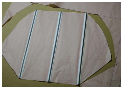
Dźwigary przyklejamy do płaszczyzny latawca
