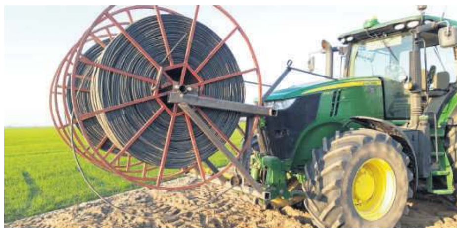
Wymyślona i skonstruowana przez pana Szymona rolka, na której zwijany i rozwijany jest wąż do nawadniania kropelkowego ziemniaków. Fot. archiwum prywatne
