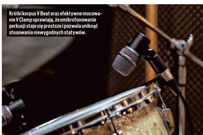
V Kick nie tylko znakomicie sprawdza się jako mikrofon do stopy zestawu perkusyjnego, ale można z niego korzystać w przypadku innych instrumentów, np. wzmacniacza do basu czy gitary.
