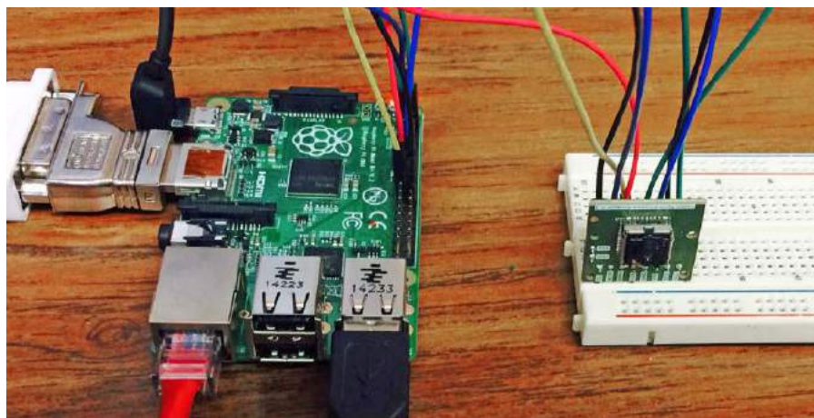
Fotografia 3. Moduł FLIR Lepton na płytce stykowej, połączony z Raspberry Pi
