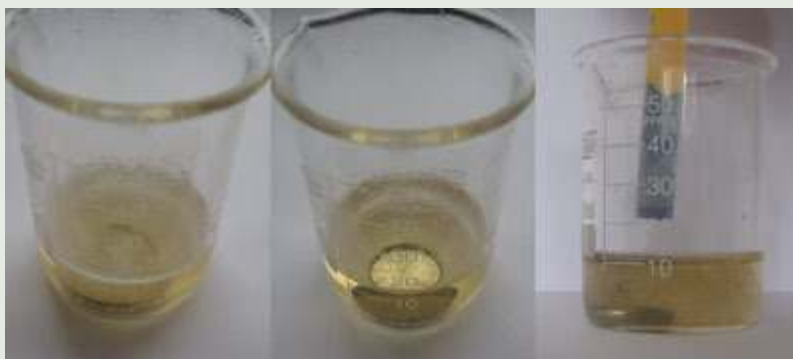
Roztworzenie litu w wodzie (od lewej): reakcja przebiegająca z wydzielaniem wodoru; widok po reakcji; badanie odczynu otrzymanego roztworu.
