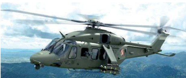
Maksymalna masa startowa: 8300 kg (możliwe zwiększenie do 8600 kg). Prędkość maksymalna śmigłowca: 313 km/h, przelotowa: 287 km/h. Maksymalny zasięg: 958 km, maksymalna długość lotu: 4 godz. i 55 minut. AW149 może zabrać na pokład 19 pasażerów. Załogę stanowią dwie osoby, ale podstawowe zadania mogą być realizowane przez jednego pilota
