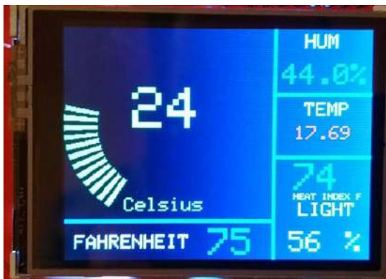
Fotografia 9. Wyświetlacz TFT TN
