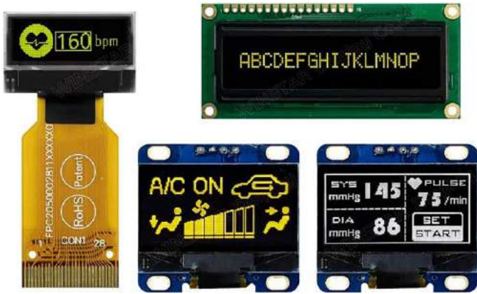
Fotografia 1. Różne rodzaje małych wyświetlaczy OLED
