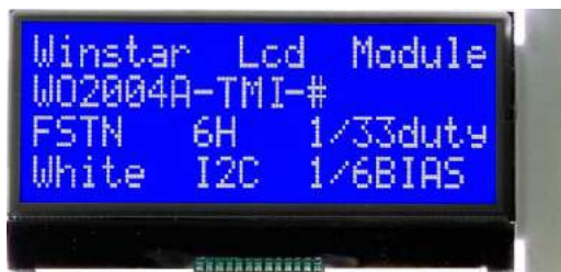
Fotografia 5. Monochromatyczny pasywny wyświetlacz LCD
