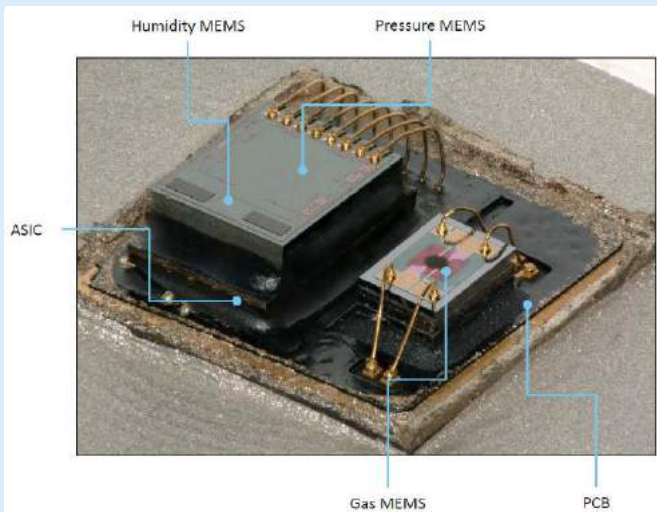
Rysunek 6. Widok wnętrza układu BME680 firmy Bosch [7]
