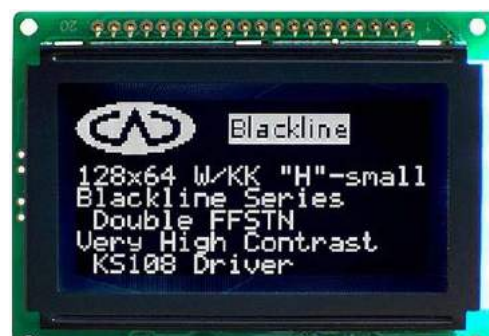
Fotografia 8. Wyświetlacz LCD FFSTN
