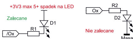
Rysunek 9. Zalecany sposób dołączania diod LED
