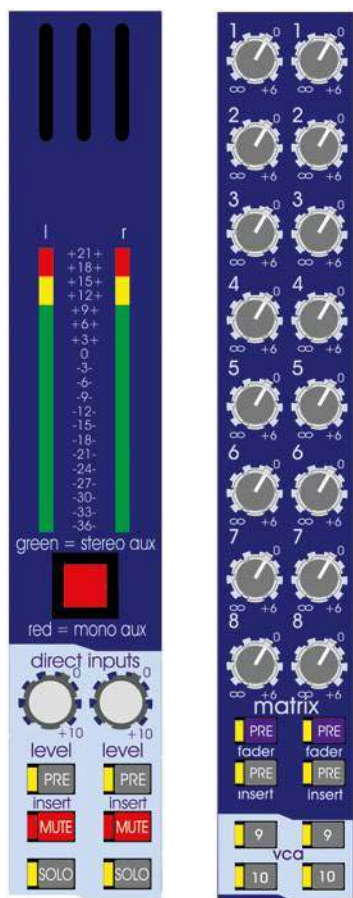
Rysunek 8. Na górze każdego z modułów grup znajduje się wskaźnik poziomu szczytowego sygnału, a pod nim kluczowy przycisk KRS, pozwalający na odpowiednie skonfigurowanie szyn wyjściowych.
