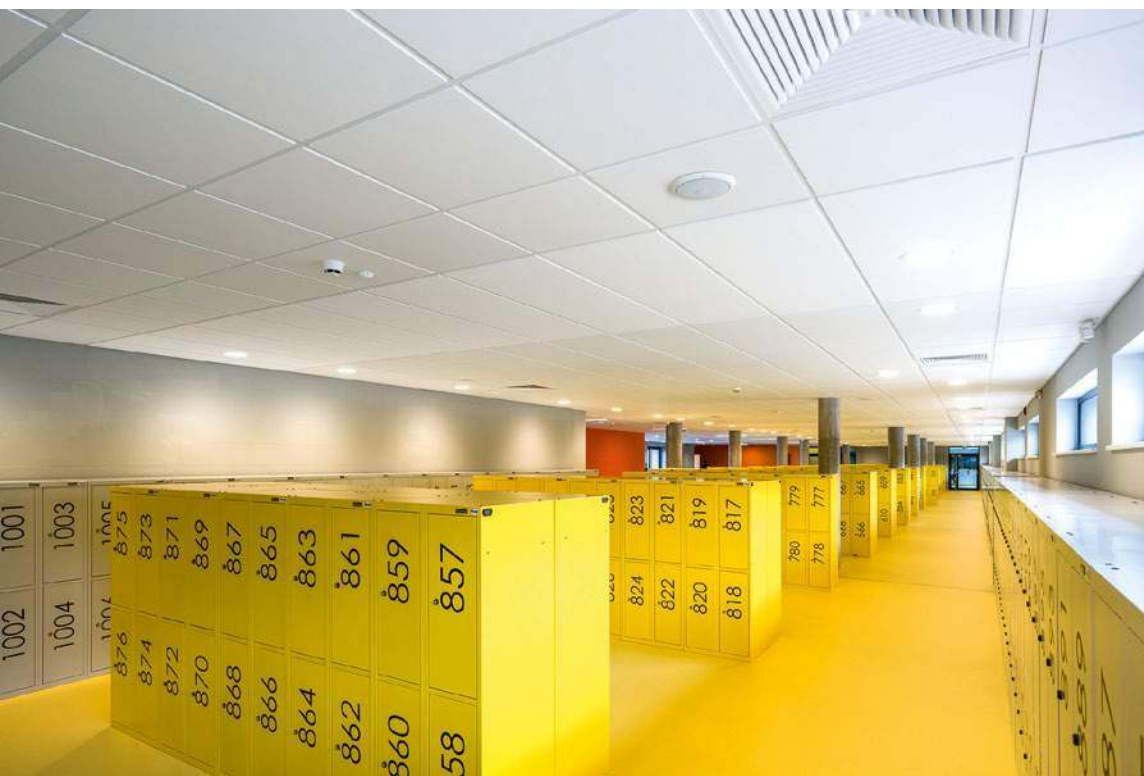
W części szkolnej w korytarzach i salach lekcyjnych zainstalowano system radiowęzła, na który składają się ściennie zestawy głośnikowe Electro-Voice z serii S oraz Dynacord z serii WL, a także sufitowe głośniki Dynacord z serii DC.
