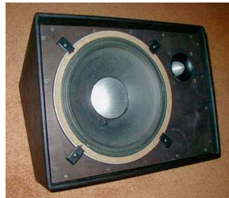
Jeden z pierwszych odsłuchów podłogowych, zbudowany na bazie przetworników JBL'a 12" E120 + 1" 2402, z racji wyglądu nazywany „pociskiem”.
