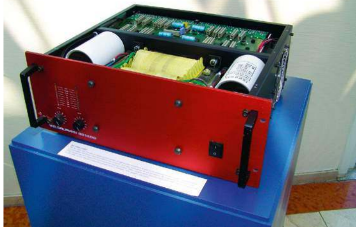
Wytwarzający 700 watów mocy na kanał wzmacniacz SS 1400 z roku 1985.
