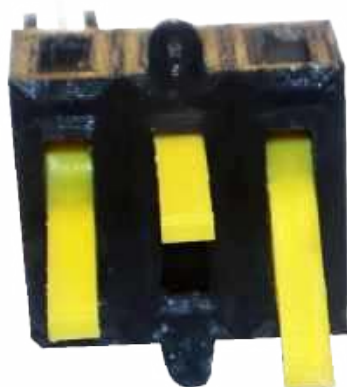
Fotografia 8. Gotowy uchwyt złożony z elementów w slicerze Cura za pomocą funkcji „Merge models”. W uchwycie umocowano przełączniki w celach demonstracyjnych
