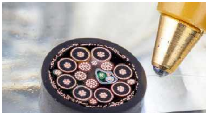
Fotografia 3. Przekrój nowoczesnego kabla USB C z widocznymi sekcjami koncentrycznymi (sygnałowymi) oraz żyłami zasilającymi o relatywnie dużym przekroju ( https://t.ly/gAGA )
