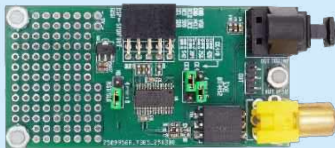
Fotografia 2. Moduł rozszerzeń szeregowego interfejsu wyjściowego SPDIF
