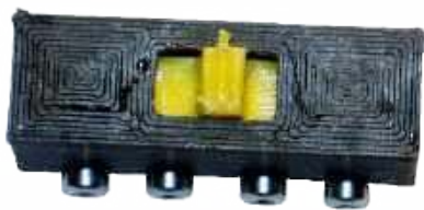
Fotografia 4. Gotowy przetątnik z rysunku 3
