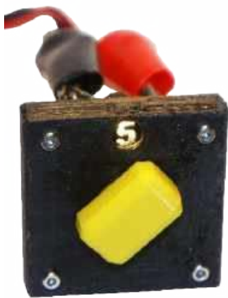
Fotografia 9. Gotowy przełącznik z diodą podświetlającą cyfrę w okienku
