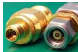
Fotografia 11. Wysokoczęstotliwościowe złącza 1,0 mm ( https://t.ly/4UpdX )
