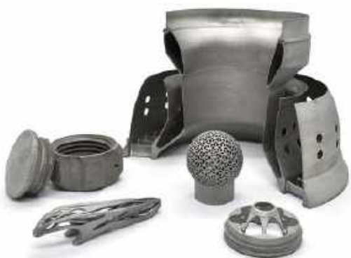
Fotografia 5. Detale wytworzone metodą selektywnego stapiania laserowego ( https://t.ly/i2Fon )
