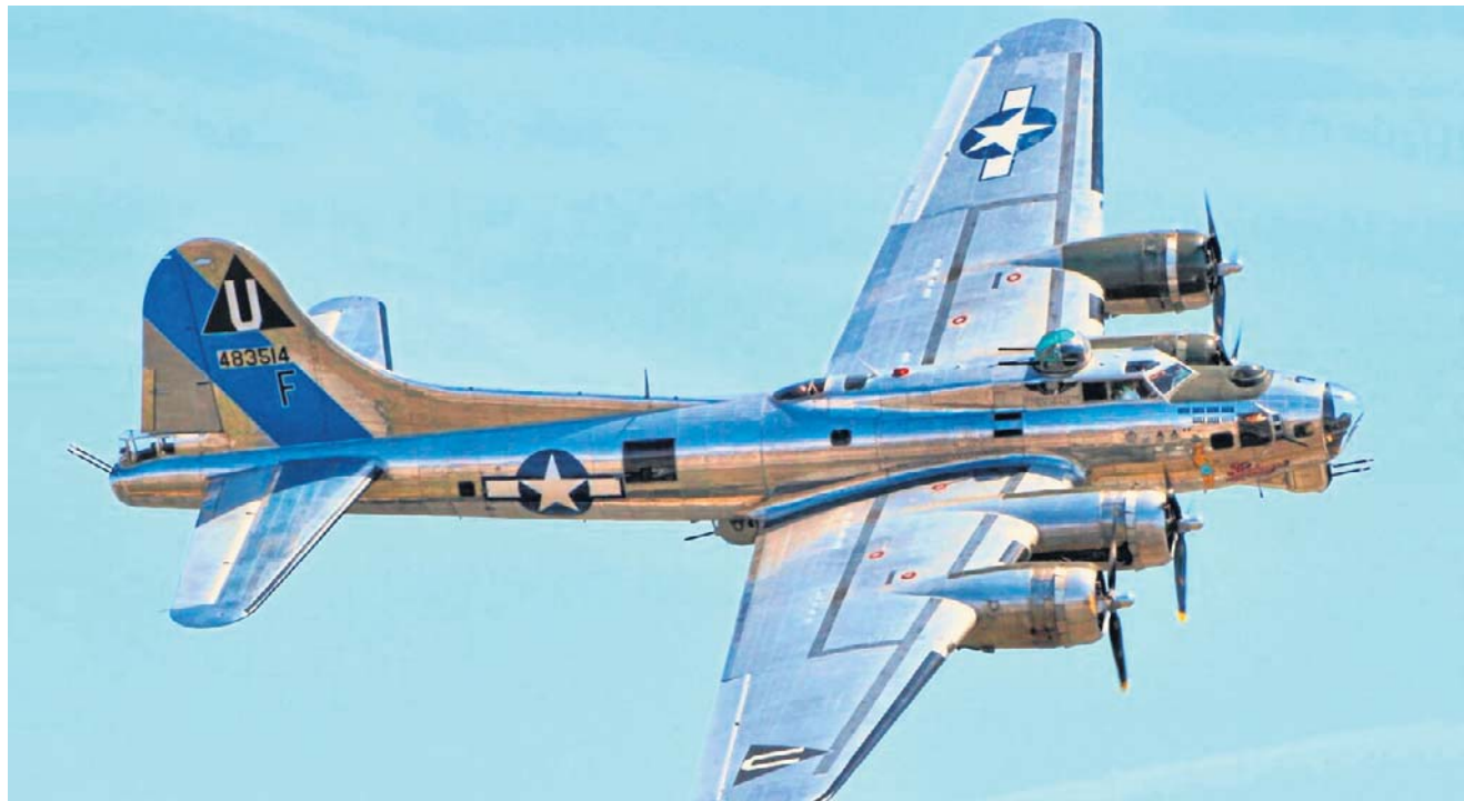
B-17G w czasie Chino Airshow 2014 w Kalifornii. Ta wersja bombowca miała w standardzie wieżyczkę podbródkową
