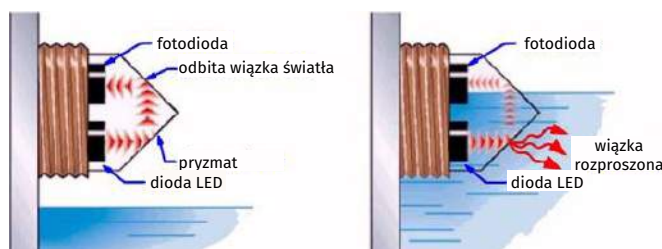
Rysunek 17. Działanie czujnika elektrooptycznego (© eptsensor.com)
