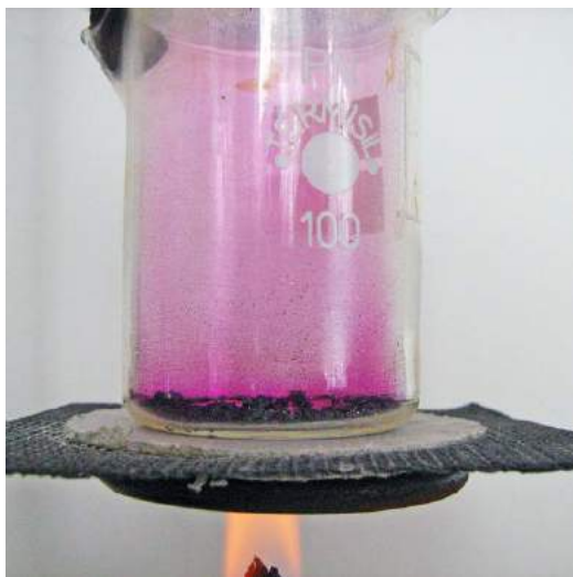
2. Ogrzewanie jodu w zlewce: widoczne fioletowe pary (sublimacja) i osadzające się na ściankach kryształy (resublimacja).
