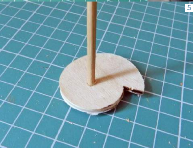
1. Elementy do budowy modelu młota. 2. Wzór krzywki naklejony na deseczkę. 3. Wycinanie krzywki dremelem z tarczą tnącą. 4. Zrobione z listwy ramiona suportu młota. 5. Krzywka poruszająca młot gotowa. 6. Przygotowanie do klejenia suportu do podstawy.
