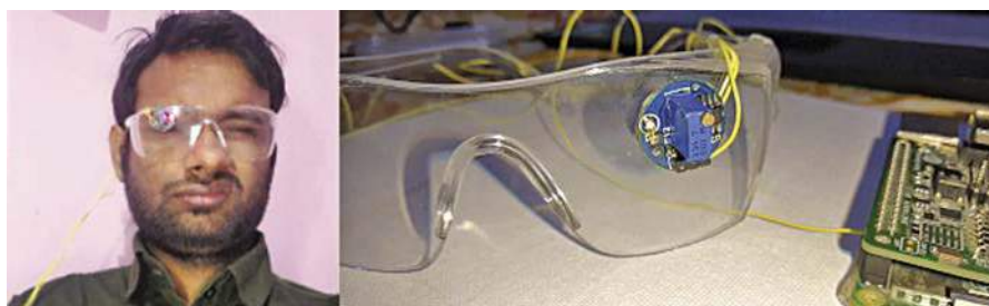
Rysunek 2. Autor testuje działanie czujnika zamknięcia powieki prawego oka
