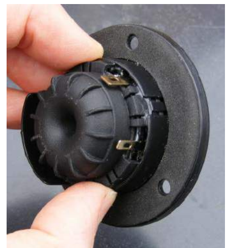
Rysunek 2. Głośnik wysokotonowy Wavecor TW022WA04 jest niewielki dzięki zastosowaniu pierścieniowego magnesu z metali ziem rzadkich.
