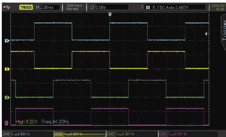
Rysunek 24. Przebiegi 2-fazowe dla dwukierunkowego sterownika unipolarnego silnika krokowego.
