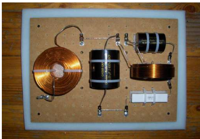
Rysunek 1.8. Zwrotnica zestawu głośnikowego w obudowie typu „Altus 300” – tor niskotonowy
