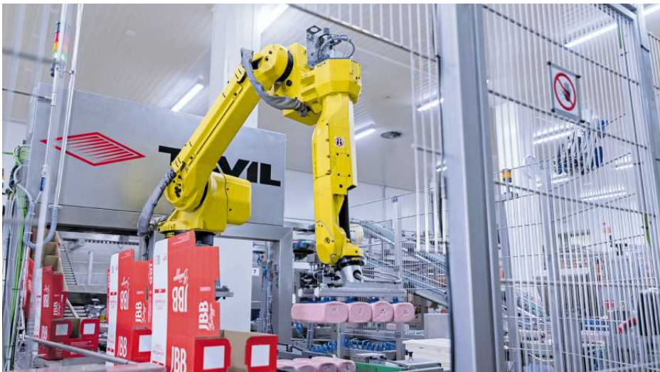
• Firma JBB zatrudnia roboty do pakowania i przenoszenia produktów mięsnych
