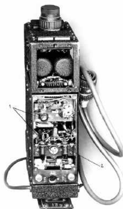
Zdjęcia 5 i 6: Nadajnik D-200, który leciał w Sputniku-1, pokazany z dwóch różnych ujęć. Na górze widać dwie duże puszkę przełączników, na których opiera się konstrukcja Manipulatora. Układy nadajnika znajdują się niżej
