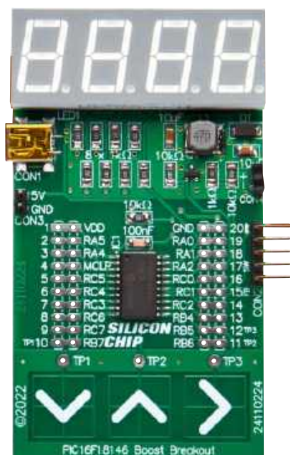
Rysunek 4. Płytkę cyfrowego stabilizatora napięcia została zbudowana głównie z elementów montowanych powierzchniowo, jednak wszystkie są stosunkowo łatwe do przylutowania. Szczególną uwagę należy zwrócić na prawidłową orientację diody, układu IC1 oraz wyświetlacza LED. Jeżeli zrezygnujesz z montażu wszystkich elementów poza IC1 i jego dwoma sąsiadującymi elementami pasywnymi, płytkę można wykorzystać jako uniwersalny moduł do eksperymentów z 20-wyprowadzeniowymi mikrokontrolerami PIC w obudowach SOIC
