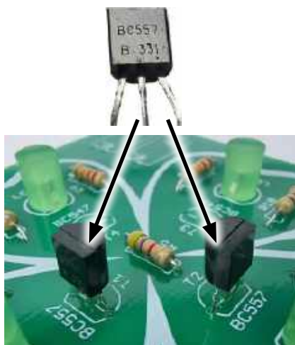
Fotografia 9. Poprawny montaż a) tranzystorów T1 i T2 (PNP) oraz b) tranzystorów T3 i T4 (NPN). Korpusy tranzystorów (w kształcie litery „D”) odpowiadają obrysom (również w kształcie litery „D”) na warstwie opisowej płytki PCB
