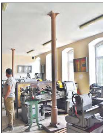
Warsztaty szkolne CKZiU, a dawniej pomieszczenia produkcyjne zakładu Janusa. Zachowały się w nich charakterystyczne dla architektury przemysłowej przełomu XIX i XX w. kolumnienki.
