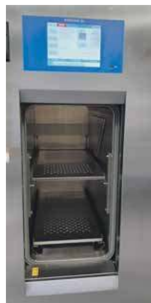
Sprzęt medyczny, narzędzia chirurgiczne są sterylizowane parą osiągającą temperaturę do 134 stopni Celsjusza
