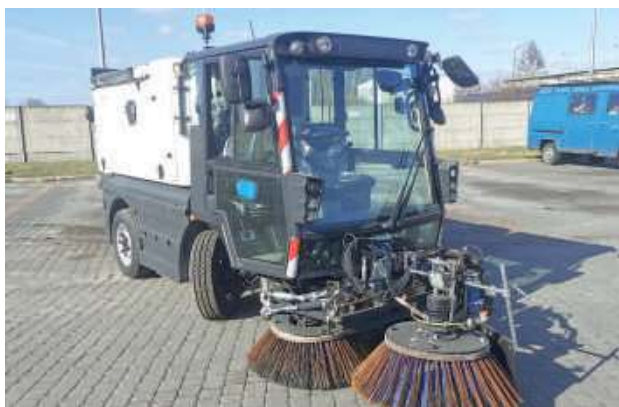
Zmiatarka Swingo 200+ ma zraszacz przy szczotkach, co powoduje, że nie będzie wzniesła chmury kurzu, jak to miało miejsce w przypadku używania zmiatarki przyczepianej do ciągnika
