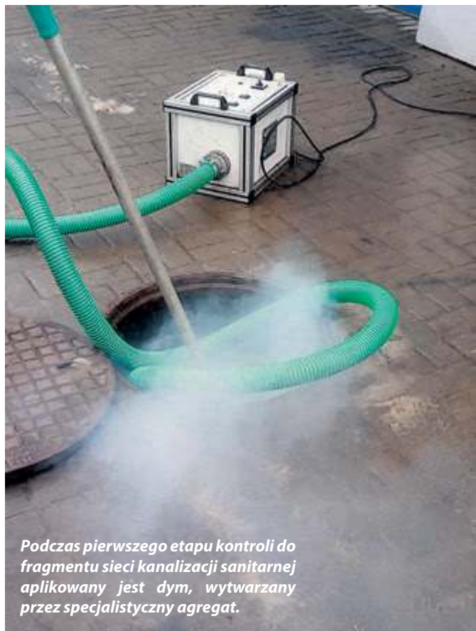
Jeżeli dym zacznie wydobywać się z rynny, oznacza to, że istnieje duże prawdopodobieństwo nielegalnego podłączenia tzw. deszczówki do kanalizacji sanitarnej. W niej powinny płynąć wyłącznie ścieki komunalne.
