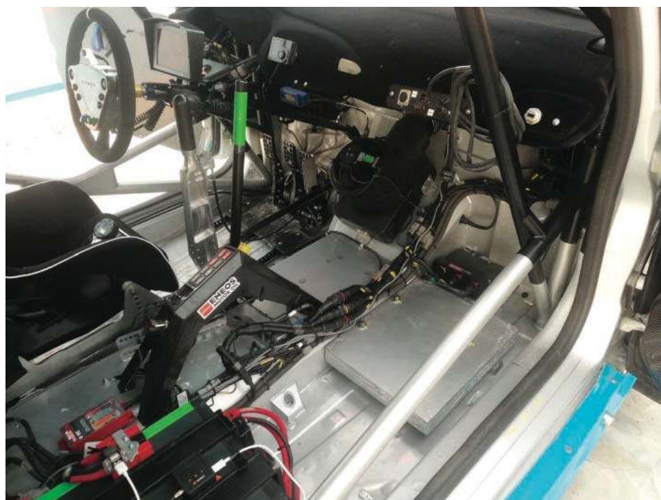
Z prawej strony podłogi zamontowano ołowianą płytę
