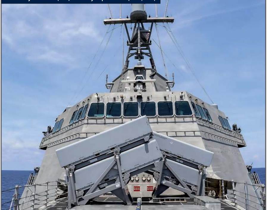
Kontenery startowe (2x4) do nowych pocisków (NSM/JSM).
