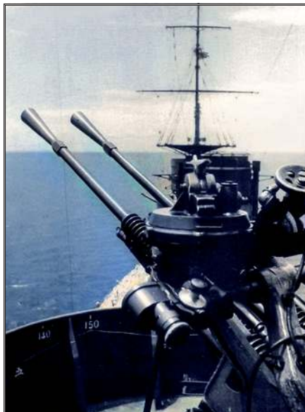
Dwudziałowe stanowiska armat plot. kal. 25 mm czy też wkm'ów 13,2 mm kal. L/76 już z chwilą ich pojawienia się na japońskich okrętach były bronią przestarzałą i mało efektywną, nawet na dystansie bezpośrednim.
