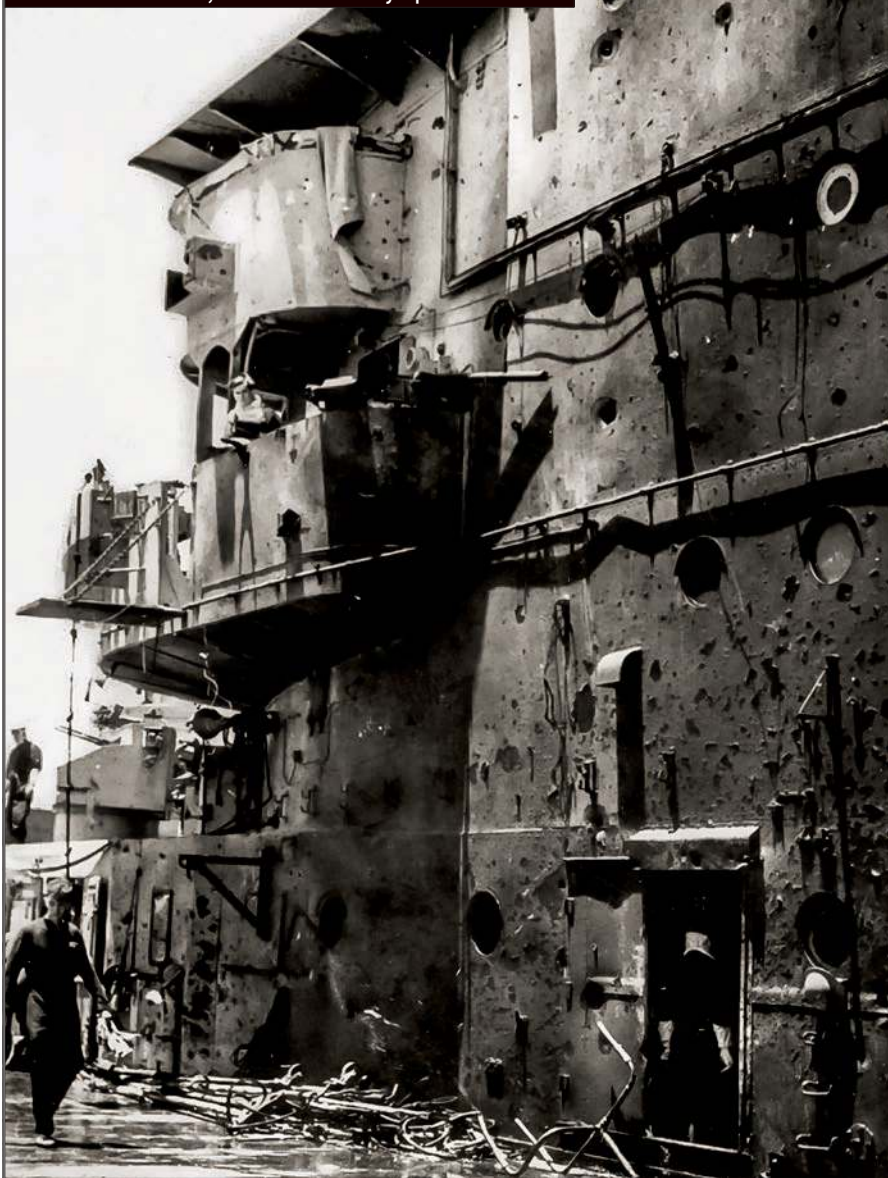
Posiekana odłamkami, osmalona ściana wysepki Formidable'a .
