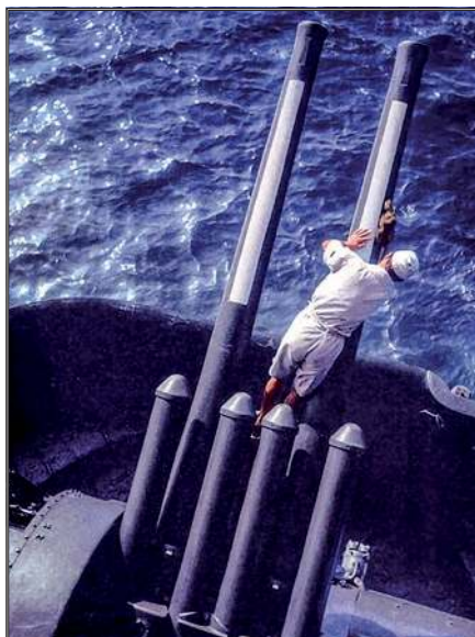
Dwudziałowe stanowisko A-1 Mod 1 lub Mod 2 do armat kal. 127 mm L/40, 89-shiki tu na pancerniku typu Fusō . Superdrednoty typu Yamato dysponowały oprócz tego także odmianą całkowicie zamkniętą A1 Mod 3.
