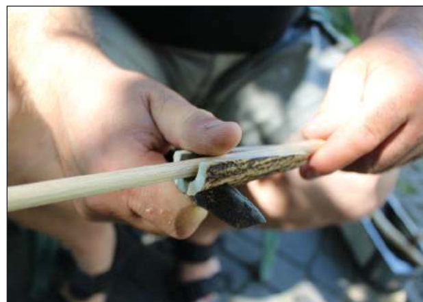
✚ Proces kształtowania strzały jest możliwy dzięki zastosowaniu prostego struga. Drewno wkładamy w rynienkę z poroża jelenia, w dolną szczelinę wkładamy ostrze noża lub innego ostrego narzędzia. Przesuwając narzędzie obrabiamy drewno
