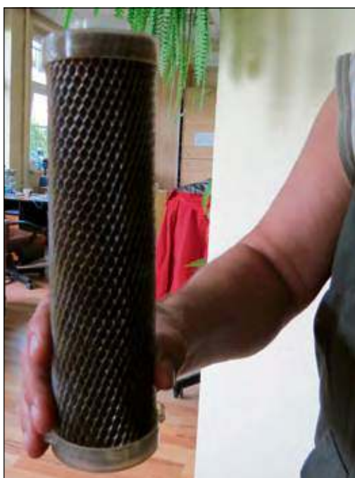
Tak wygląda filtr wody w Gogolinie po niecałych trzech miesiącach użytkowania.
