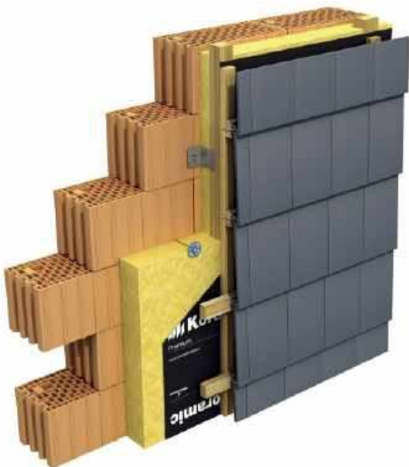
Dachówki na elewacji układa się luźno, ale konieczne jest mechaniczne przymocowanie każdej do drewnianego lub metalowego rusztu. WIENERBERGER
