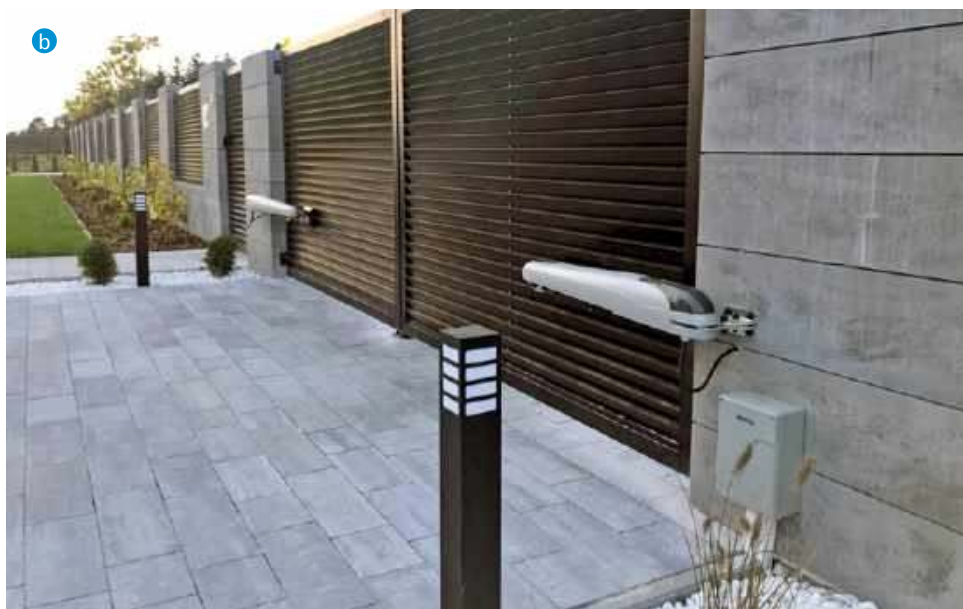
📌 Inne napędy stosuje się do bram wjazdowych przesuwnych (a), inne do rozwieranych (b). Chodzi przede wszystkim o konstrukcję siłowników. Na każdy napęd składają się silnik, centrala sterująca oraz mechanizm przenoszący siłę ciągu silnika na bramę. BENINCA
