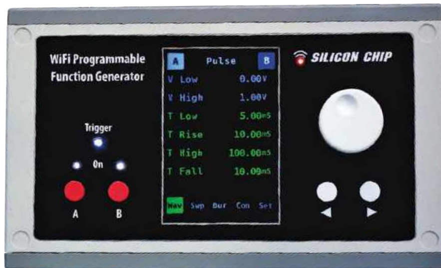
Gotowy generator funkcyjny DDS z obsługą Wi-Fi. Ekran dotykowy służy do wybierania funkcji, natomiast pokrętko i przyciski pozwalają ustawiać wartości oraz niezależnie włączać i wyłączać kanały
