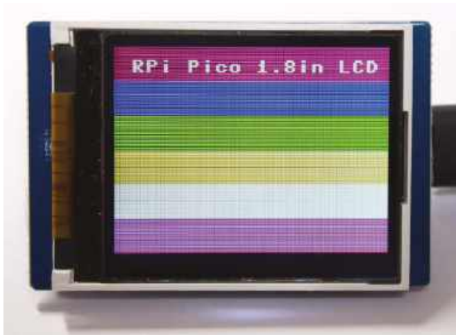
Fotografia 1. Kolorowe pasy wyświetlane na wyświetlaczu LCD Waveshare o przekątnej 1,8 cala
