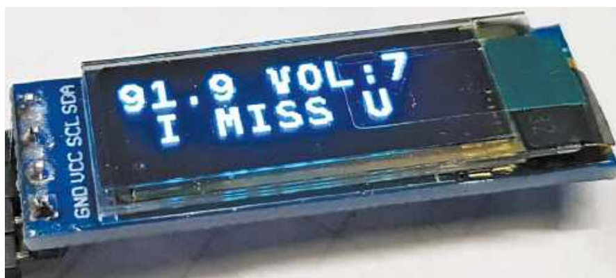
Rysunek 9. a) OLED 128x32, b) OLED 128x64
