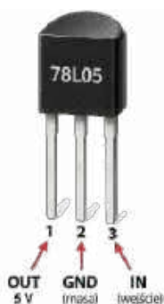
Rysunek 10. Opis wyprowadzeń stabilizatora 78L05
