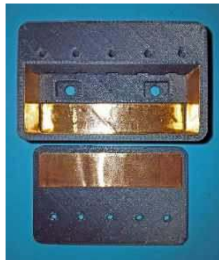
Rysunek 10. Obidwie części wydruku 3D po oklejeniu folią miedzianą
