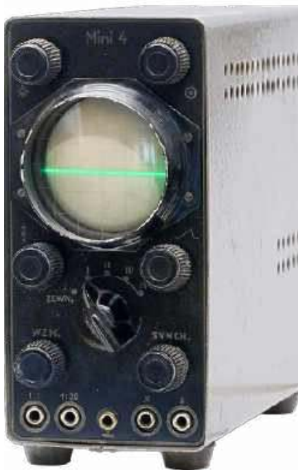
Rysunek 1. Wygląd zewnętrzny oscyloskopu typu Mini 4
