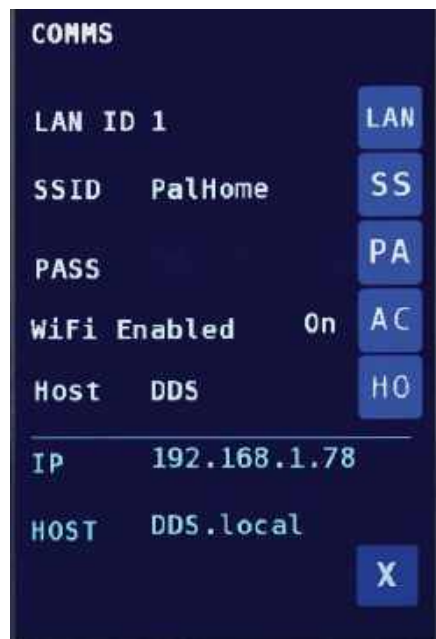
Ekran 7. Dostęp do menu ustawień komunikacji („COMMS”) uzyskuje się z menu ustawień, do którego można przejść, naciskając przycisk SET na ekranie głównym
