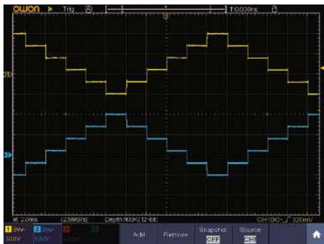
Oscylogram 10. Sygnał kanału A jest odwracany w kanale B (niebieska krzywa), gdy włączone jest sprzężenie, a przesunięcie fazy jest ustawione na wartość większą niż 0° dla przebiegów skokowych i impulsowych
