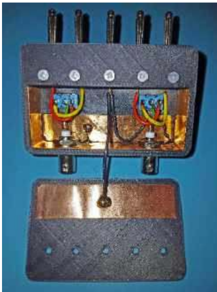
Rysunek 12. Wygląd zewnętrzny przejściówki BNC do oscyloskopu Mini 4 podczas montażu
