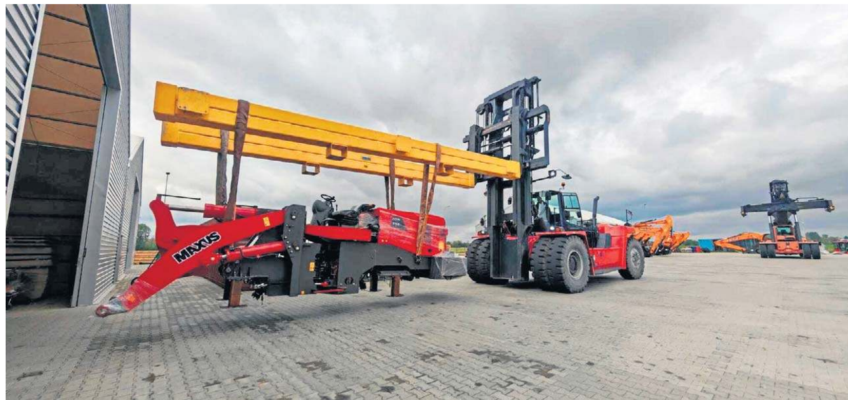
Wózek widłowy o udźwigu 54 ton z unikatowym osprzętem daje przewagę Cargo Lift w oferowaniu niestandardowych usług przeładunkowych
