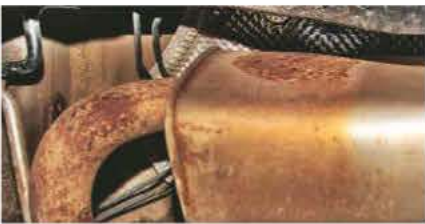
WYDECH w większości wygląda bardzo dobrze, ale punktowo niestety koroduje.
