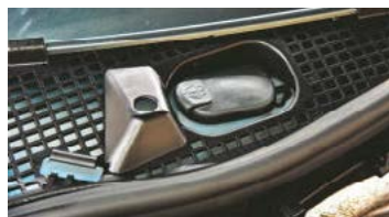
Wlew płynu do spryskiwaczy znajduje się na podszybiu. Mało wygodne.
