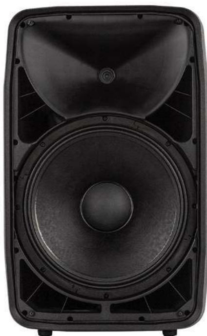
HDM 45-A to konstrukcja dwudrożna w obudowie bass-reflex, wykonanej z kompozytu polipropylenowego, oparta na głośniku 15-calowym.
