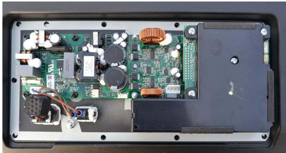
Cała elektronika mieści się na jednej płycie – DSP, układy wejściowe i końcówki mocy zamknięte są w szczelnej puszcze plastikowej.
