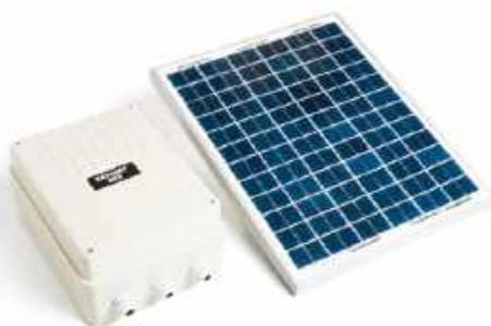
❷ Zestaw solarny do bram wjazdowych składający się z panelu solarnego, kontrolera ładowania i dwóch akumulatorów 12 V/9 Ah. Zestaw można podłączyć do napędu bramy przesuwanej lub skrzydłowej. Zasilanie solarne umożliwia montaż napędu do bramy tam, gdzie nie ma dostępu do zasilania elektrycznego. SUKCES GROUP
