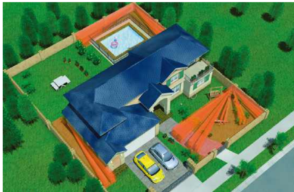
Na posesji oraz na obwodzie budynku montuje się bariery podczerwieni. Wysyłają one wiązki promieniowania, których przecięcie uruchamia alarm. OPTEX SECURITY
